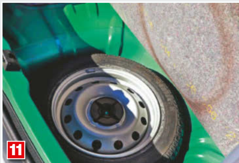
11 WŃĘKA NA KOŁO. Zbyt luźny składany dach i nieuszczelnności powodują, że do wnętrza przenika woda.
