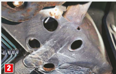
2 PODŁUŻNICE. Obszar narażony na odpryski spod przednich kół i wilgoć, a później rozwój korozji.
