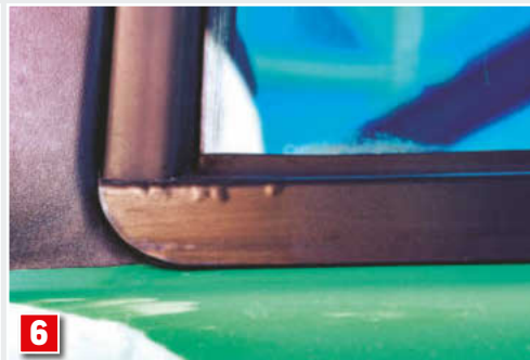
6 USZCZELKI I LISTWY. Pęcherze świadczą o korozji metalowego rdzenia. Zostaje wymiana części na nową.
