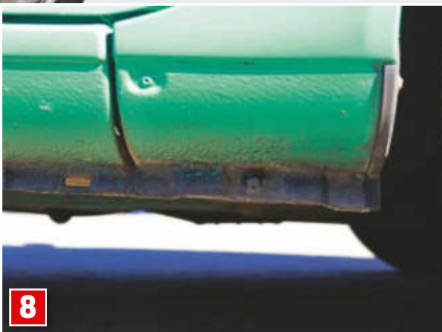
8 PROGI. Nieprawidłowo ustawiony podnośnik czy uderzenia kamieni powodują korozję.
