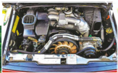
Od 1996 r. w 3,6-litrowym bokserze stosowano system Varioram, który zwiększał moc do 285 KM.
