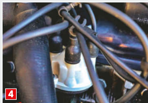
4 POKRYWA ROZDZIELACZA ZAPŁONU. Psuje się, więc warto wozić w aucie zapasową kopolkę.
