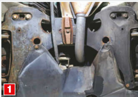
1 RAMA POMOCNICZA. W starszych samochodach potrafi bywa przrzedziewiała na wylot.
