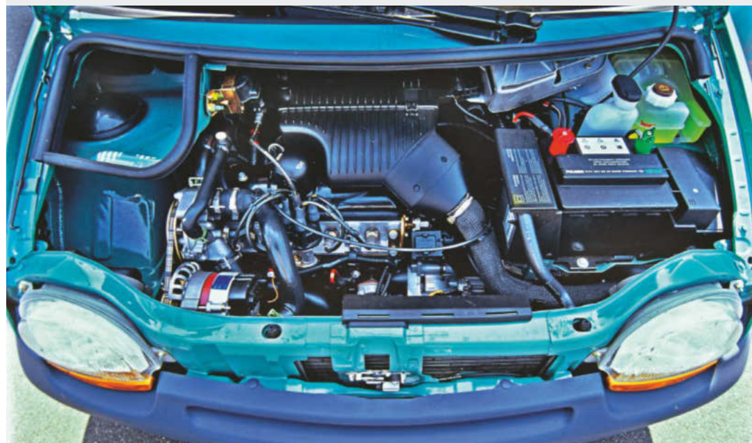
Montowana w pierwszych modelach 54-konna jednostka wywodzi się jeszcze od czterocylindrowego silnika Renault 5. Na dzisiejsze standardy to technicznie archaiczna już konstrukcja z wałkiem rozrządu w bloku (OHV).
