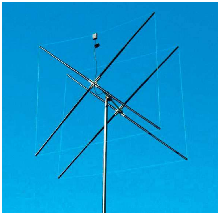
Fot. 1. Widok zainstalowanej anteny dla pasma 6 m
