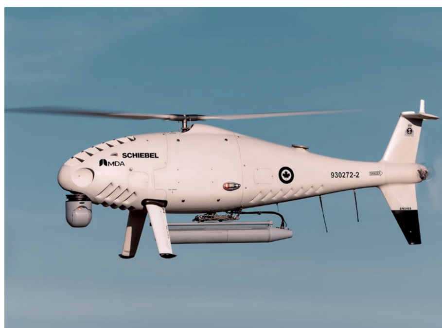
▲ W 2025 roku na potrzeby Marynarki Wojennej kupiono dwa (z sześciu planowanych) bsp pionowego startu i lądowania w układzie śmigłowca Schiebel Camcopter S-100 (CU-179 Peregrine ). Pierwszy z nich został dostarczony w lipcu br. Camcoptery są przeznaczone do służby na pokładach fregat typu Halifax .
