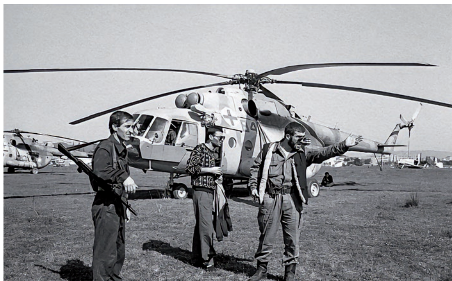
▲ Ukraińskie śmigłowce Mi-8MTW na lotnisku Kopitnari podczas misji w Gruzji w październiku 1993 r. Maszyna z numerem burtowym czerwony „84” posiada zestaw tzw. „afgańskich” modyfikacji, obejmujący opancerzone płyty chroniące kabinę załogi, wyrzutnie flar termicznych, a także wciągarkę ratowniczą zamontowaną nad bocznymi drzwiami.
