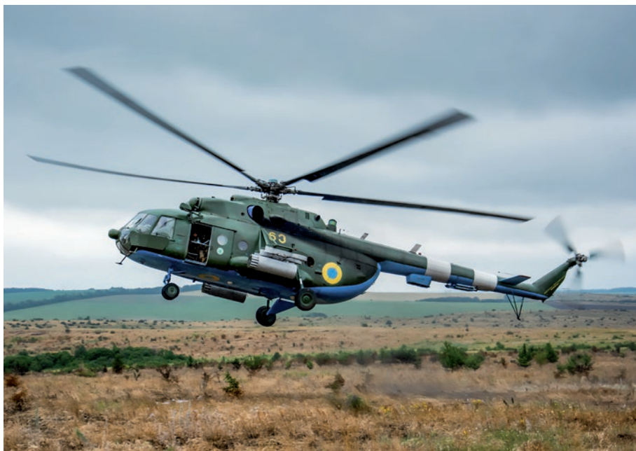
▲ Śmigłowiec Mi-8MT (nr boczny żółty „60”) z 16. Samodzielnej Brygady Lotnictwa Armijnego, uzbrojony w wyrzutnie B8W20 dla niekierowanych pocisków rakietowych S-8 (2014 r.).
