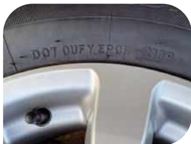
Stan i wiek opon w przyczepie są bardzo ważne. Widoczne na zdjęciu ostatnie cztery cyfry DOT wskazują datę produkcji. W tym przypadku jest to 21. tydzień 2019 r.
