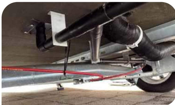
Kładąc się pod przyczepę, ocenimy, czy przypadkiem nie ma luźnych mocowań instalacji oraz konieczności konserwacji podwozia i miejsc mocowań armatury
