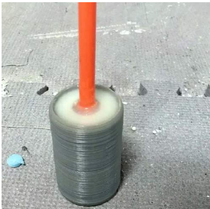
Rysunek 4. Sposób montażu przeciwwagi na końcu wskazówki
