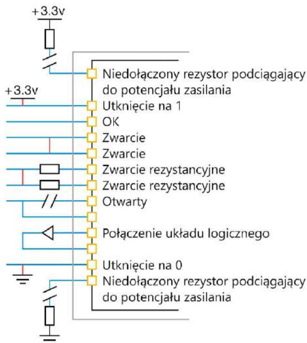
Rysunek 2. Testowanie układu z użyciem XJTAG pozwala wykryć m.in. niedołączony rezystor podciągający do potencjału zasilania, zatrzaśnięcie na 1, zwarcie, przerwę itd.
