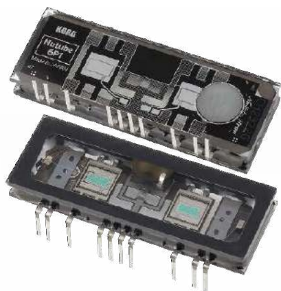
Fotografia 1. Lampa Nutube 6P1 (z materiałami Korg)
