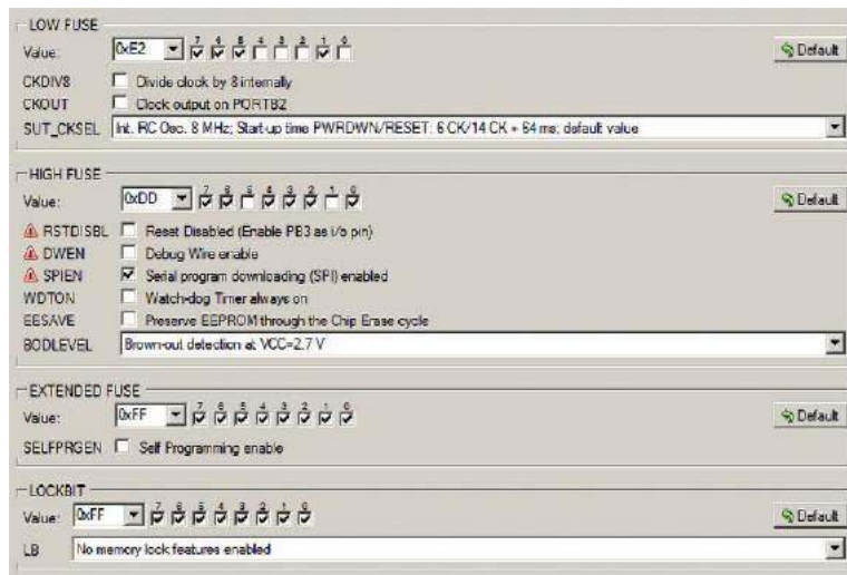
Rysunek 5. Ustawienie fuse-bitów mikrokontrolera Attiny24A
