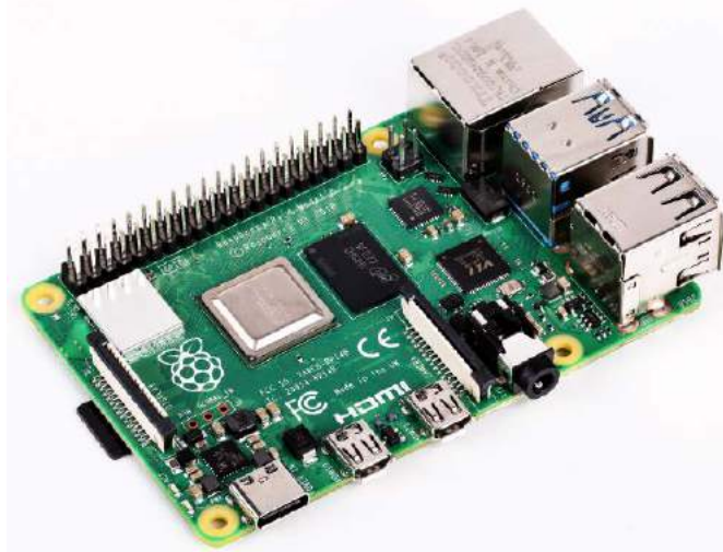
Fotografia 1. Raspberry Pi 4 Model B z 4 GB RAM
