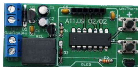
Fotografia 5. Widok zmontowanego urządzenia od strony TOP bez zamontowanego wyświetlacza OLED
