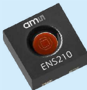
Rysunek 6. Układ ENS 210
