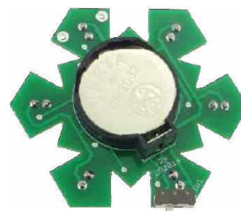
Fotografia 5. Zmontowany układ pokazany od strony baterii
