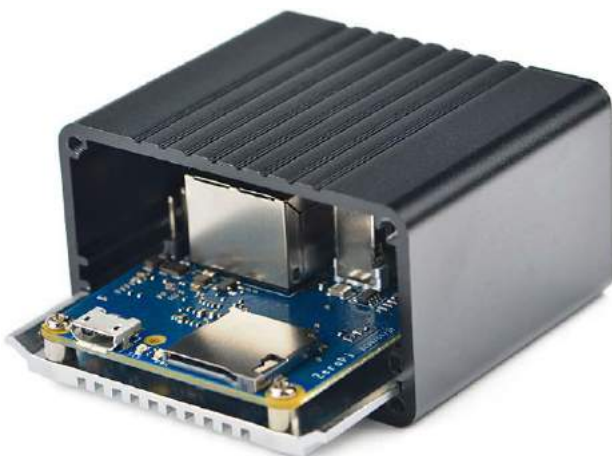
Fotografia 15. ZeroPi w trakcie wsuwania w metalową obudowę
