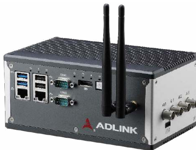
Fotografia 7. Komputer przemysłowy firmy Adlink, przeznaczony do monitorowania stanu sprawności maszyn przemysłowych
