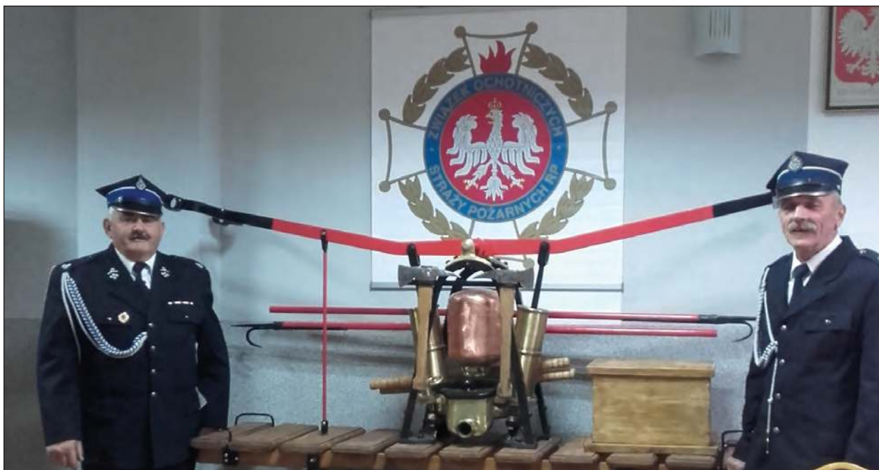
■ Krzysztof Jazurek oraz Marek Markiewicz przywrócili dawny blask pompie ręcznej. Całość została wypięskowana. Mosiężne elementy zabezpieczone bezbarwnym lakierem, a stalowe pomalowane na oryginalny czarny oraz czerwony kolor
