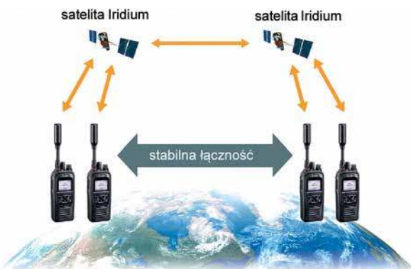
Rys. 2. Zasada łączności satelitarnej przy użyciu radiotelefonów IC-SAT100
