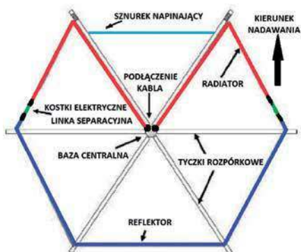
Rys. 1. Szkic konstrukcji anteny Hexbeam 6 m
