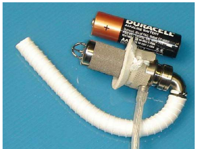
Fotografia 24. Jarvik 2015 – jeden ze współcześnie stosowanych modeli pomp do wspomagania lewej komory serca (LVAD). Niewielkie urządzenie jest przeznaczone dla małych dzieci, stąd tak kompaktowe wymiary całości (porównanie z baterią typu AA). Źródło: https://t.ly/gylr
