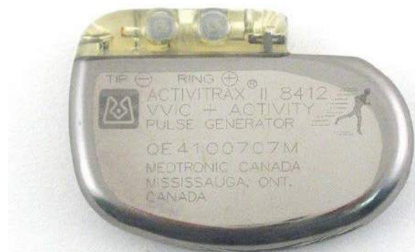
Fotografia 19. Pierwszy rozrusznik dostosowujący częstotliwość generatora do aktywności ruchowej pacjenta – model Activitrac II 8412 firmy Medtronic. Uwagę zwracają niewielkie wymiary urządzenia, pomimo zaimplementowania w nim dodatkowej funkcjonalności (60×43×12 mm). Źródło: https://t.ly/_BeE
