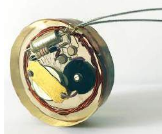
Fotografia 7. Replika pierwszego rozrusznika wszczepialnego (Rune Elmqvist, Ake Senning). Źródło: https://t.ly/L0o-
