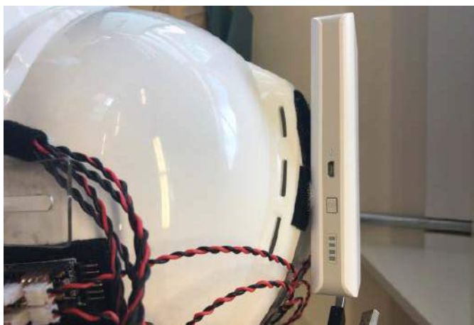
Fotografia 8. Akumulator zamontowany w górnej części kasku
