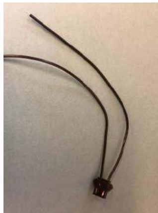
Fotografia 2. Wtyczka JST z krótkimi przewodami przylutowana do sensora zgięcia
