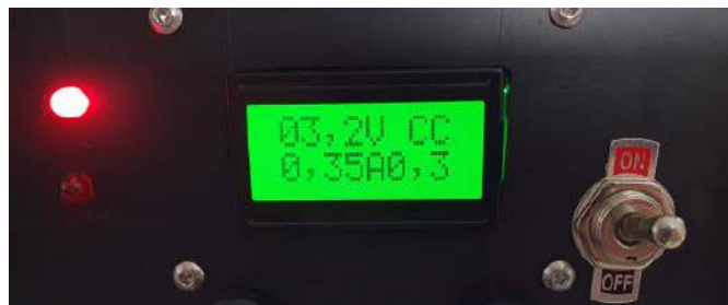
Fotografia 8. Wygląd płyty przedniej po zadziałaniu układu ograniczenia prądowego
