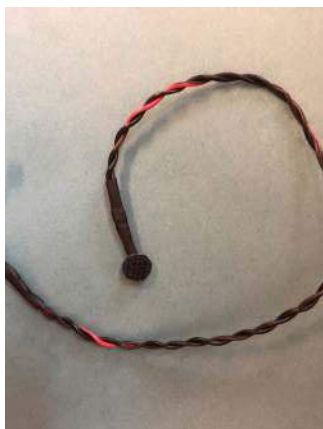
Fotografia 6. Silnik wibracyjny przygotowany do zamontowania w kasku
