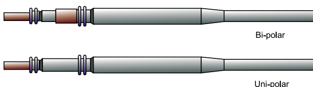
Rysunek 13. Porównanie konstrukcji złączy IS-1 Bi (na górze) i IS-1 Uni (na dole). Czerwone elementy oznaczają pola stykowe, niebieskie – uszczelnienia, pozostała część to izolacja przewodu oraz złącza ( https://t.ly/nwUq )
