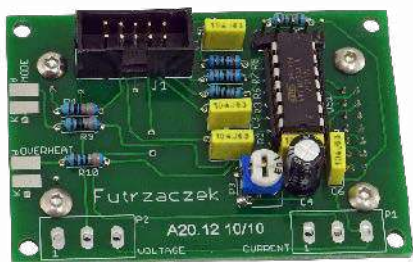
Fotografia 3. Zmontowana płytka przednia – widok od tyłu
