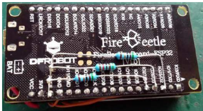
Fotografia 2. Oporniki podciągające na płycie (uwaga – oporniki powinny podciągać do pinu 3V3, a nie AREF, jak na zdjęciu)
