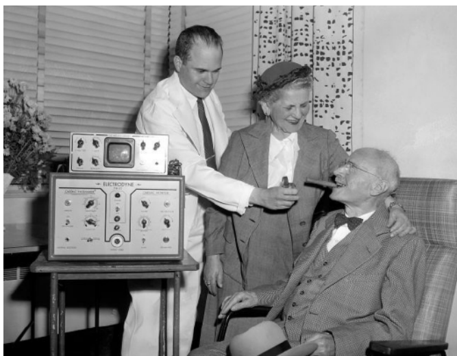
Fotografia 3. 76-letni Pincus Shapiro (po prawej) – pierwszy pacjent, który otrzymał 3-miesięczną terapię rozrusznikiem zewnętrznym PM-65 (dolny, większy moduł generatora impulsów stymulujących był wyposażony w dodatkową „nadstawkę” EKG z niewielką lampą oscyloskopową, widoczną na górze urządzenia). W środku – żona pacjenta, po lewej – Seymour Furman, kardiolog ( https://t.ly/9zB0 )
