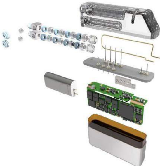
Rysunek 29. Widok rozstrzelony przykładowego stymulatora wszczepialnego ( https://t.ly/Z7ZD )
