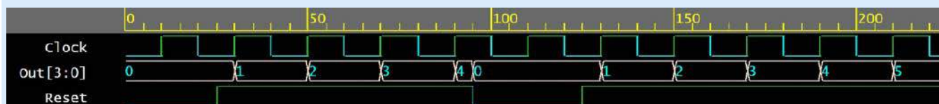
Rysunek 1. Symulacja licznika, którego działanie definiuje kod z listingu 4
