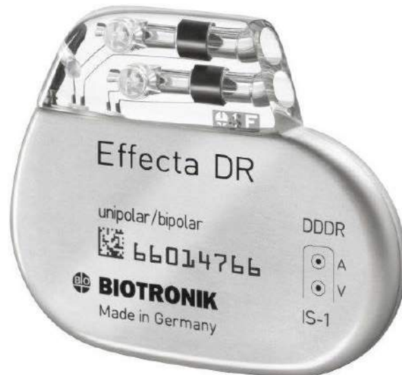
Fotografia 1. Nowoczesny rozrusznik dwujamowy z automatyczną regulacją częstości impulsów stymulujących (DDDR) – model Effecta DR marki Biotronik ( https://t.ly/Obnz )
