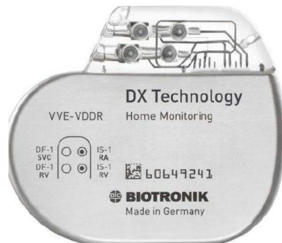
Fotografia 4. Kardiowerter-defibrylator z serii DX marki Biotronik ( https://t.ly/Tpfi )
