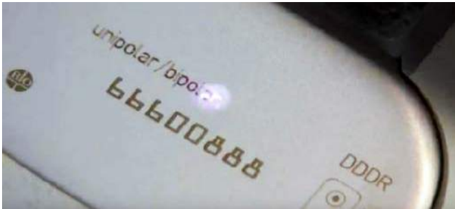
Fotografia 18. Znakowanie laserowe obudowy implantu ( https://t.ly/oaf7 )
