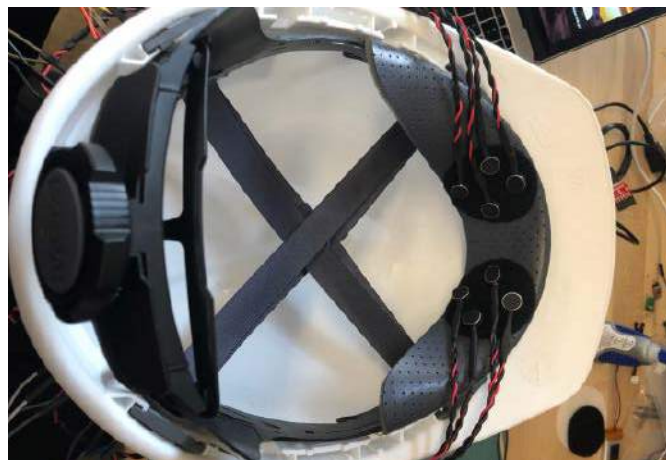
Fotografia 7. Efekторы haptyczne zamontowane po wewnętrznej stronie kasku
