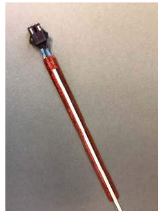
Fotografia 2. Wtyczka JST z krótkimi przewodami przylutowana do sensora zgięcia
