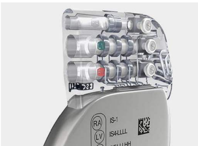
Fotografia 17. Blok gniazd do podłączenia elektrod we współczesnym urządzeniu do terapii CRT ( https://t.ly/xdwl )
