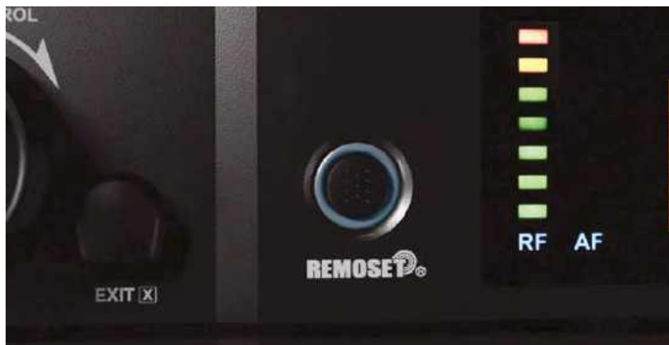
Funkcja REMOSET, aktywowana dedykowanym przyciskiem na panelu czołowym odbiornika, komunikuje odbiornik z nadajnikiem, nawet jeśli nie znajduje się on w jego „polu widzenia”.
