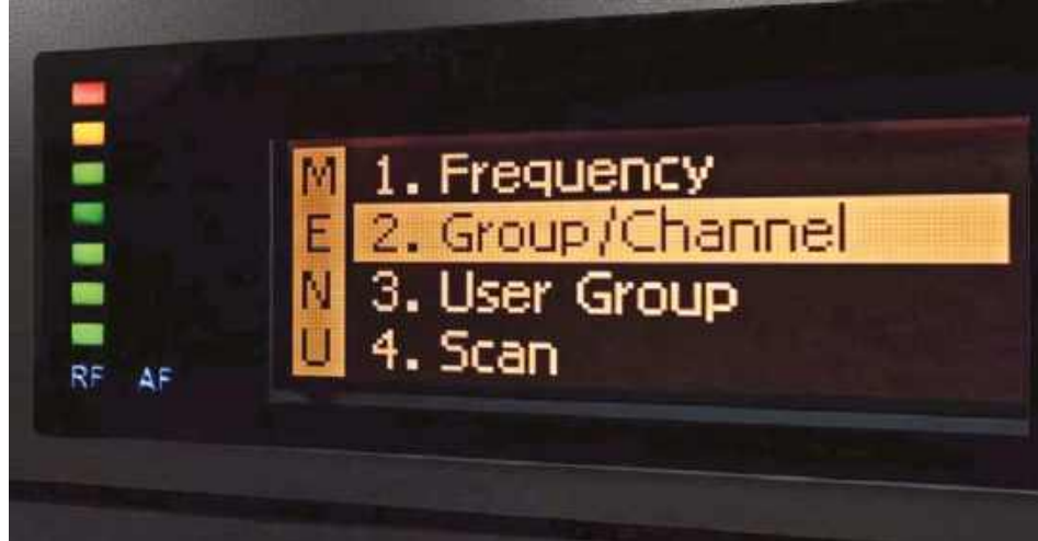
Na przednim panelu UF-20R znajduje się – osobno dla każdego kanału – spory, czytelny wyświetlacz LCD i dwa diodowe wskaźniki (poziomu sygnału RF i audio).
