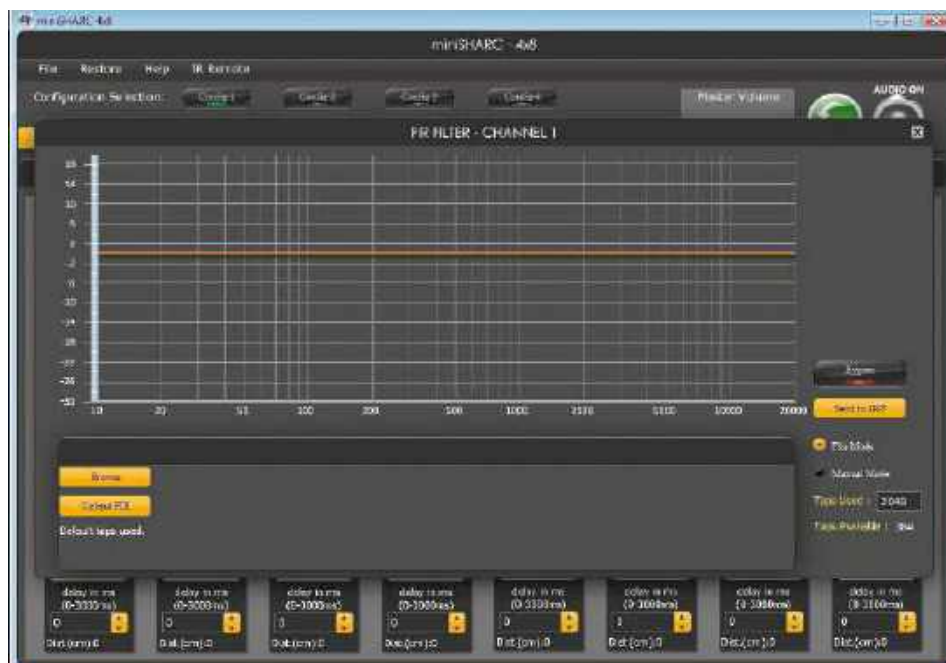
Rysunek 1. Okno filtru FIR w oprogramowaniu sterującym DSP miniSHARC firmy miniDSP – wciskając „Browse” wczytujemy z pliku .bin współczynniki filtru, a następnie przyciskiem „Send to DSP” wysyłamy je do procesora.
