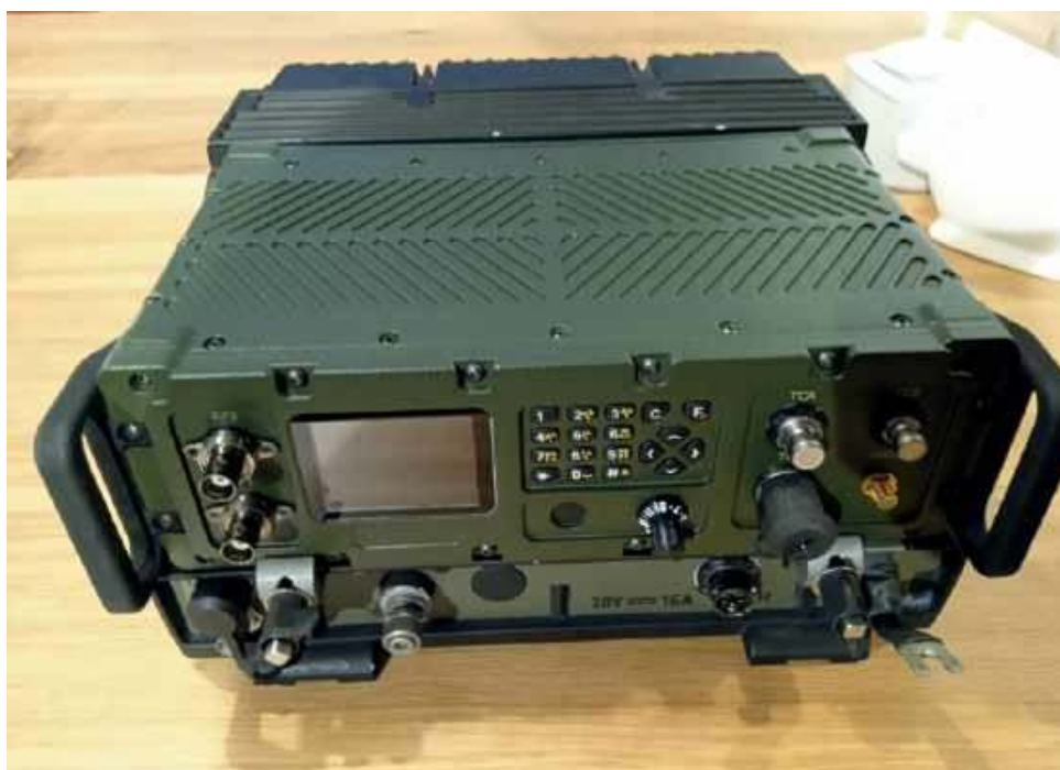
Radiostacja pokładowa COMP@N-Z w obudowie wymiarowo zgodnej z RRC9310, aby możliwe było bezproblemowe zastąpienie urządzenia na tym samym wzmacniaczu
