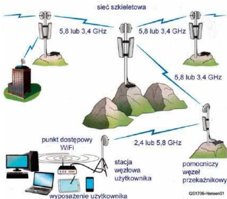
Rys. 1. Przykładowa struktura sieci. Węzły użytkowników są połączone z węzłami sieci bezpośrednio albo w miarę potrzeby przez pośredniczące węzły przekaźnikowe (źródło: [1])
