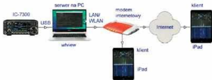
Rys. 1. Konfiguracja sprzętu dla zdalnego sterowania IC-7300
