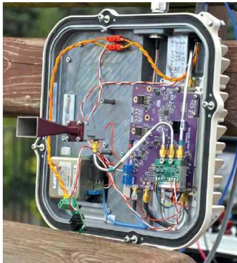
Tak wygląda (zdjęta górna obudowa) urządzenie do łączności w paśmie 24 GHz. Brązowy lejek po lewej stronie to antena tubowa. Ma wymiary u wylotu 2×15 cm i długość 8 cm
