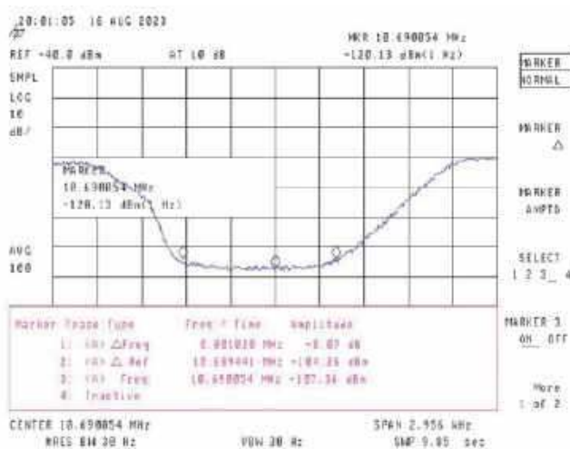
Rys. 4. Pomiar szerokości notcha w podstawie filtra 10,690033 MHz
