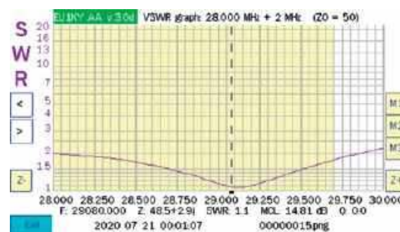
Rys. 7. WFS anteny zmierzony wraz z kablem zasilającym (22 m RG58)
