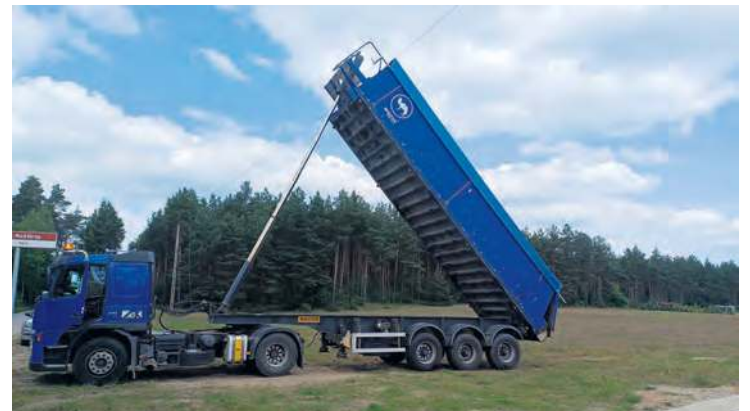
Do zerwania linii energetycznej doszło przy podnoszeniu naczepy ciągnika siodłowego.
