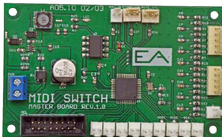
Fotografia 10. Widok zmontowanego obwodu drukowanego modułu sterującego
