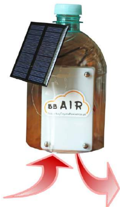
Rysunek 4. Gotowy sensor w pomysłowej obudowie
