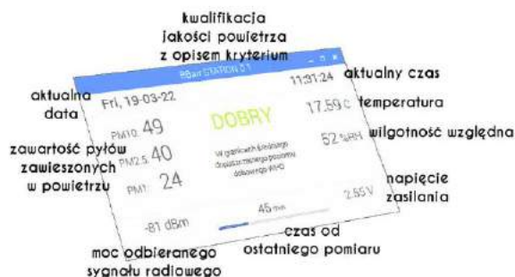
Rysunek 1. Wyniki pomiarów zaprezentowane w atrakcyjnej formie na czterocalowym, graficznym wyświetlaczu LCD
