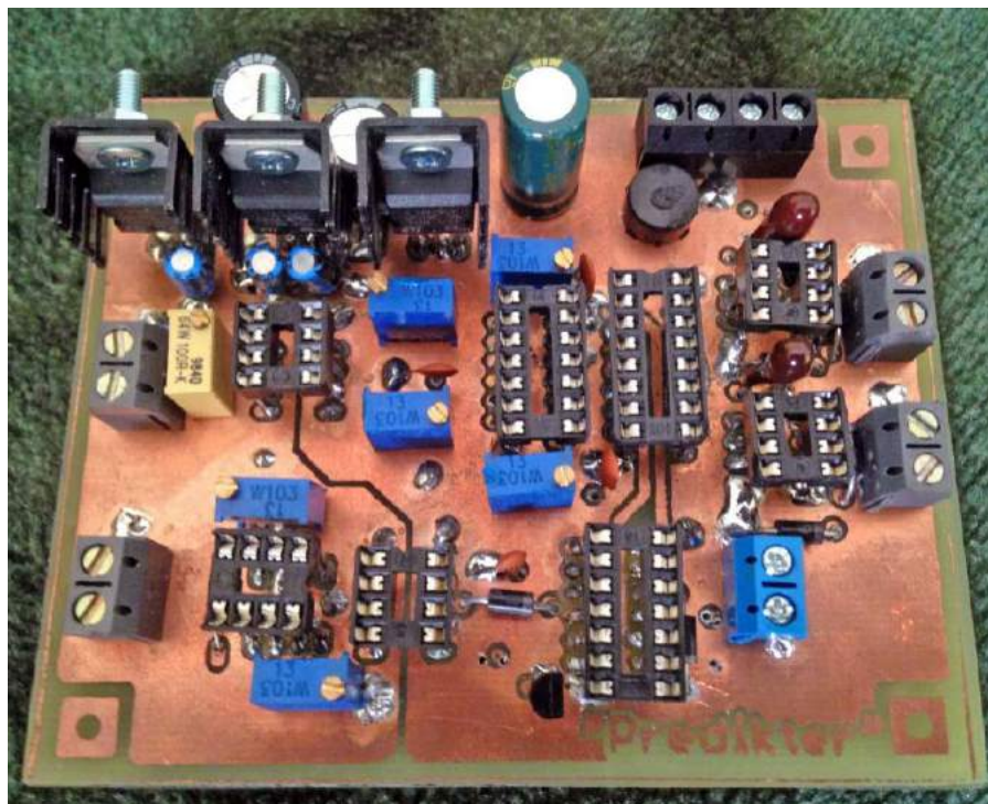
Fotografia 7. Wygląd zmontowanej płytki sterownika
