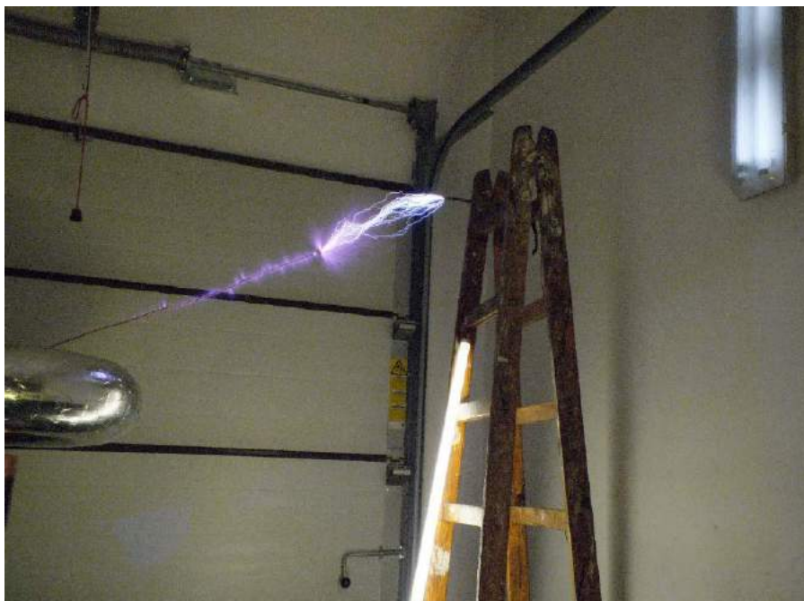
Fotografia 1. Uruchomiony transformator Tesli, długość wyładowań osiąga 50 cm
