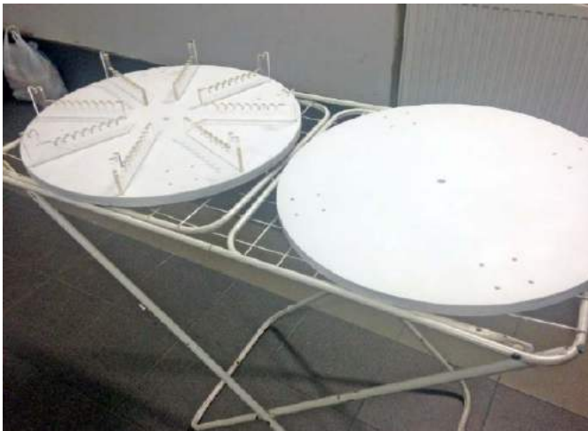
Fotografia 16. Elementy podstawy uzwojenia pierwotnego
