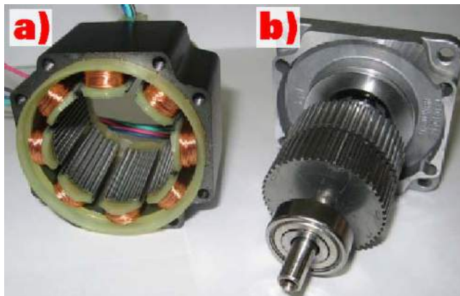
Fotografia 6. Silnik hybrydowy: a) stator, b) rotor
