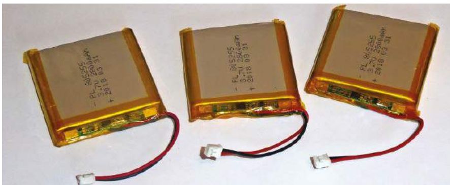
Rysunek 8.11. Trzy tanie akumulatory LiPo o kształcie idealnym do wbudowania w małe i przenośne urządzenia elektroniczne.
