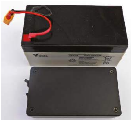
Rysunek 8.13. Akumulatory kwasowo-ołowiowe (3,2 Ah - góra) i LiPo (2,8 Ah - dół) o podobnych parametrach. Zestaw akumulatorów autora wykorzystuje trzy szeregowo połączone ogniwa LiPo i jest znacznie bardziej kompaktowy i lżejszy od akumulatora kwasowo-ołowiowego.
