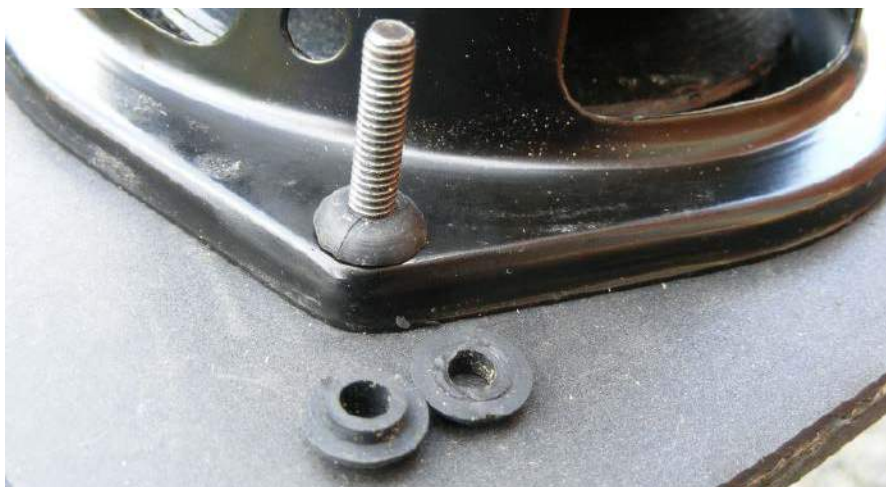
Rysunek 11. Uszczelnienie otworów montażowych na tylnym mocowaniu głośnika niskotonowego w LS3/5A może być trudne. Dobrym rozwiązaniem są gumowe podkładki lub przelotki kablówkowe przycięte na pół
