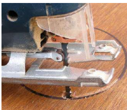
Rysunek 1. Wycinanie otworu na głośnik w prymitywny sposób za pomocą wyrzynarki. Zwróć uwagę na wywiercony otwór startowy wewnątrz okręgu
