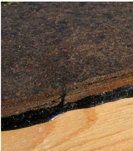
Rysunek 20. Podkładka tłumiąca przymocowana do panelu. Zwróćcie uwagę na dużą ilość Aquasealu do jego przyklejenia
