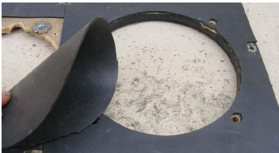
Rysunek 8. Przyklejenie arkusza gumy neoprenowej do przegrody LS3/5A w celu zapewnienia dobrego uszczelnienia i tłumienia obudowy dla głośnika niskotonowego B110
