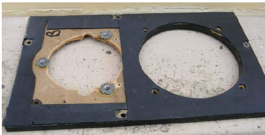
Rysunek 5. Nakrętki kłowe (typu T) założone dla głośnika wysokotonowego T27 z tyłu ścianki (wewnątrz obudowy). Ponieważ T27 jest montowany z przodu, zgrabnie zakrywa „surowe” wycięcie
