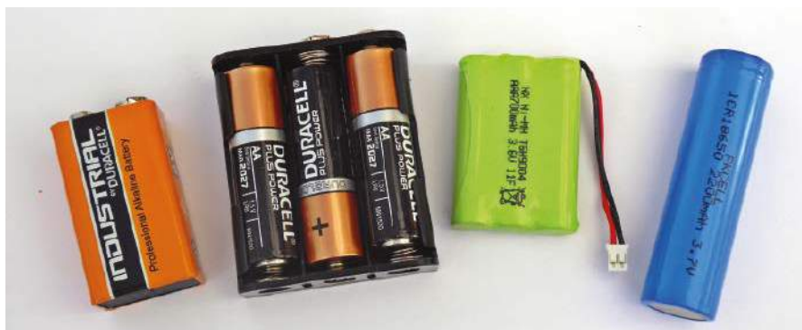
Rysunek 8.1. Kilka typowych zestawów akumulatorów do małych urządzeń elektronicznych. Od lewej do prawej: bateria alkaliczna PP3 9 V oparta na sześciowarstwowych ogniwach 1,5 V; pakiet baterii 4,5 V oparty na trzech ogniwach alkalicznych 1,5 V; pakiet 3,6 V oparty na trzech ogniwach Ni-MH; pojedyncze ogniwo Li-ion o dużej pojemności 3,7 V.
