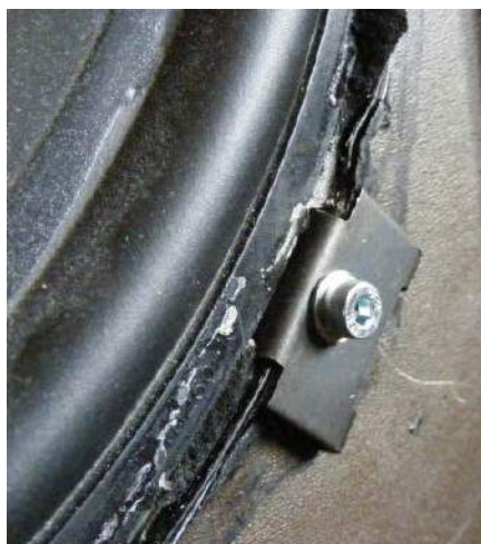
Rysunek 7. Dostępne są specjalistyczne zaciski głośnikowe do mocowania głośników na obrzeżcu
