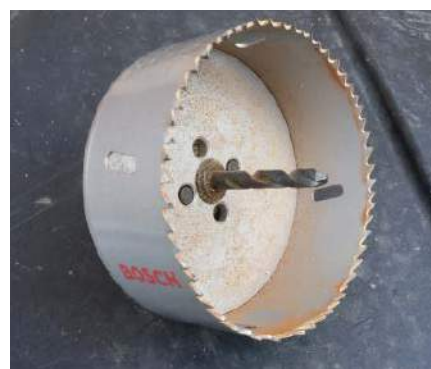
Rysunek 2. Odpowiednia otwornica z zębami daje dokładniejszy otwór. Należy często podnosić frez, aby usunąć pył i wióry
