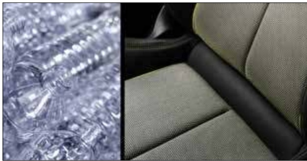
Do obicia wszystkich siedzeń w Audi A3 wykorzystuje się 45 butelek PET o pojemności 1,5 litra. Ponadto dywaniki w tym modelu zrobione są z materiału powstałego z kolejnych 62 butelek
