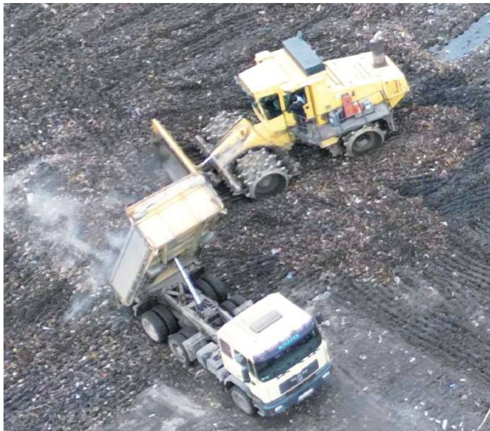
Beżowa ciężarówka marki MAN kilkadziesiąt razy dziennie wozi stabilizat na dystansie około 300 m, kipruje odpady do niecki, po czym wraca jakieś 100 m po kolejną porcję stabilizatu.
