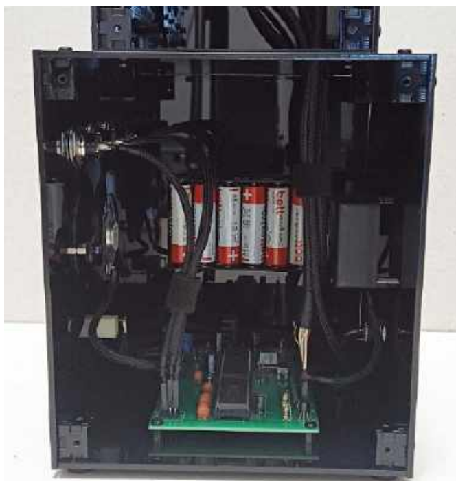
Fotografia 8. Spięcie przewodów za pomocą rzepów
