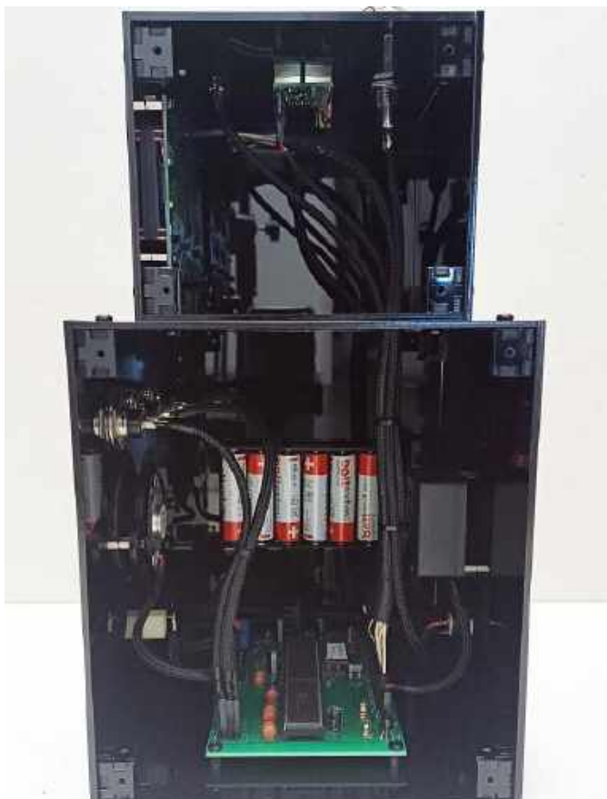
Fotografia 4. Połączenia pomiędzy płytką drukowaną a komponentami elektronicznymi znajdującymi się na obudowie urządzenia
