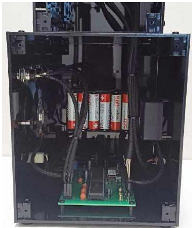
Fotografia 7. Spięcie przewodów za pomocą opasek kablowych
