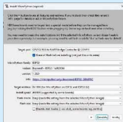
Rysunek 4. Parametry instalacji MicroPythona w ESP32
