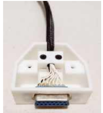
Fotografia 12. Uchwyt kabla zintegrowany z obudową
