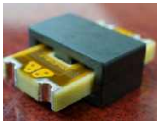
Fotografia 11. Przykładowy transformator planarny ( https://t.ly/3fjoa )
