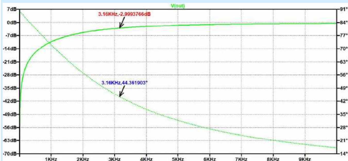
Rysunek 10. Charakterystyka częstotliwościowa prostego, górnoprzepustowego filtra RC (symulacja)
