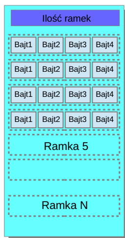
Rysunek 6. Reprezentacja danych pojedynczej ścieżki dźwiękowej w pamięci karty SD
