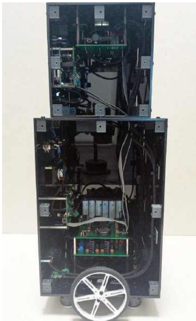
Fotografia 1. Zastosowanie przewodów taśmowych w urządzeniach modułowych
