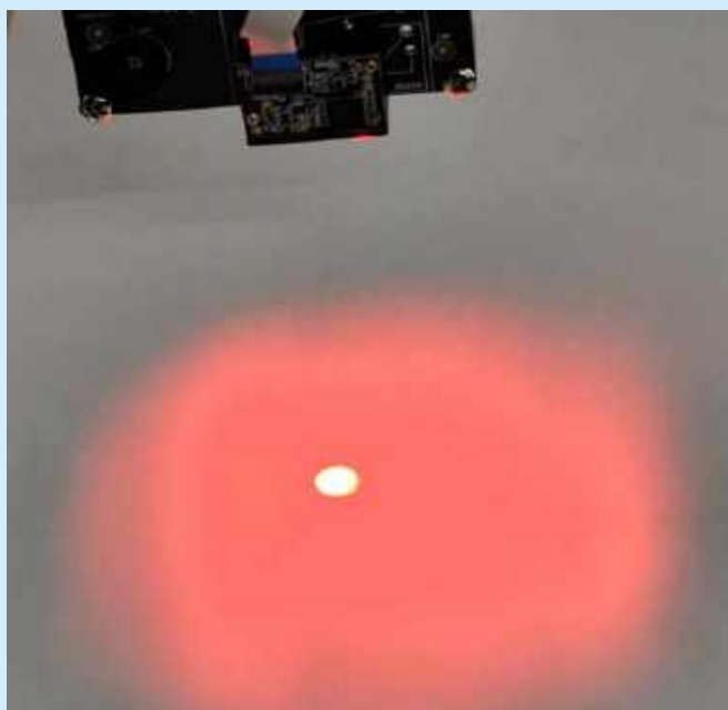
Fotografia 1. Światło emitowane przez wbudowany oświetlacz oraz celownik modułu EM3296V4
