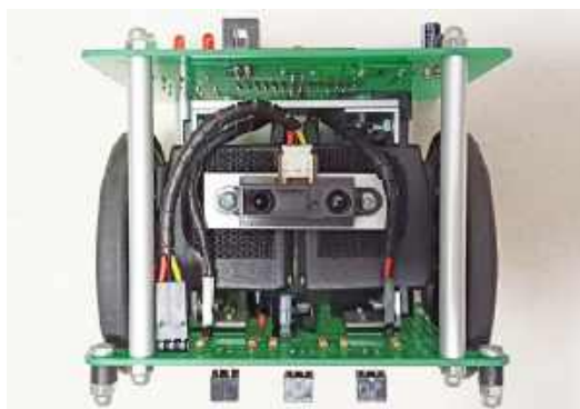
Fotografia 5. Zastosowanie spiralnej owijki do zabezpieczenia przewodów
