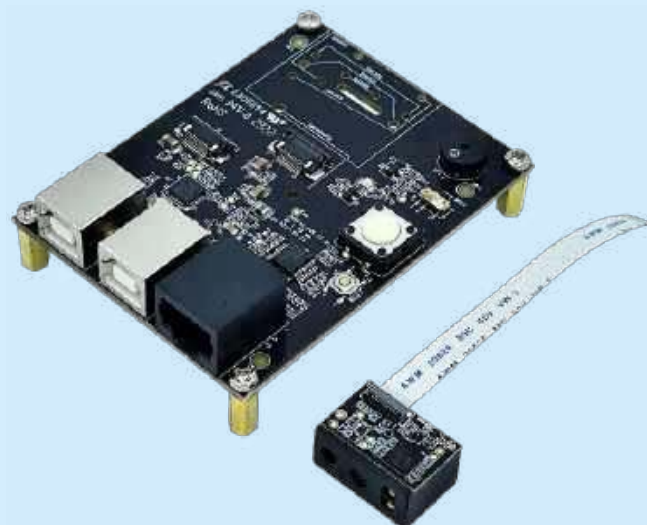
Fotografia 3. Widok płytki EVK3030 wraz z modułem EM3296V4
