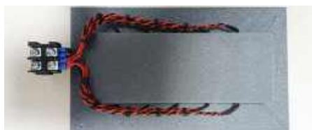
Fotografia 6. Skręcenie ze sobą pojedynczych przewodów
