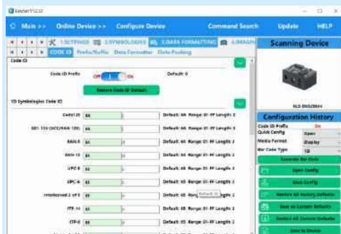
Rysunek 9. Okno konfiguracji prefiksów identyfikujących rodzaj zeskanowanego kodu
