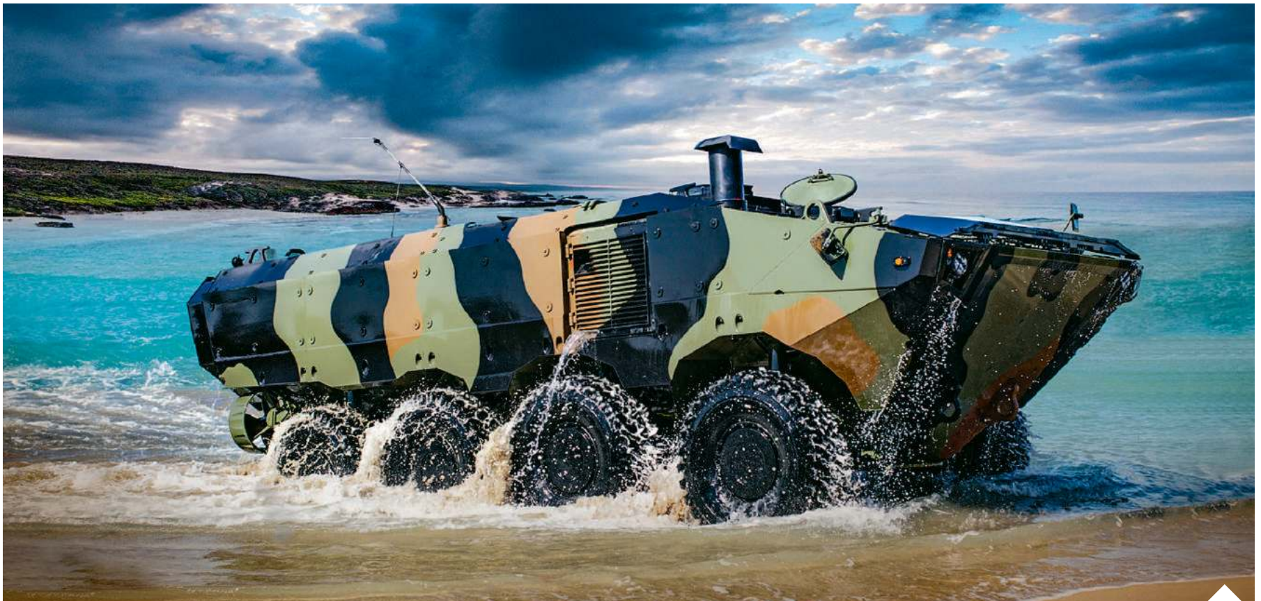
ACV wyposażona jest w sześciocyndrowy silnik o mocy 690 KM, dzięki któremu może osiągnąć prędkość 105 km/h na lądzie i 10 km/h w wodzie. Zasięg ACV na lądzie wynosi 800 km, a w wodzie 64 km. Oprócz trzech członków załogi pojazd może zabrać trzynastu żołnierzy desantu | fot. U.S. Navy/d
