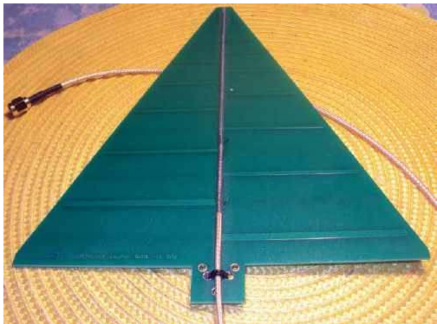
Antena logarytmiczno-periodyczna obejmująca pasma 23–6 cm
