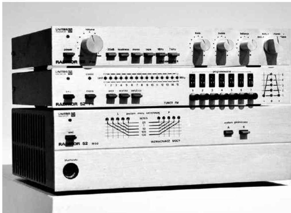
Zestaw RADMOR 52: tuner FM F10, przedwzmacniacz sterujący P40 i wzmacniacz mocy W50
