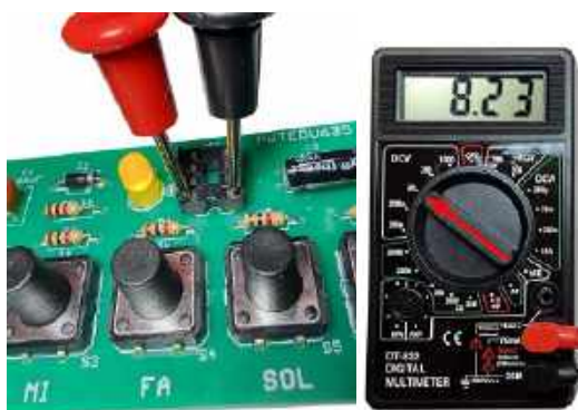
Fotografia 17. Pomiar na zaciskach 8 („plus”) i 1 („minus”) podstawki pod układ NE555 wskazał poprawne napięcie baterii (bez znaku „-”, który sugerowałby błędną polaryzację), pomniejszone o spadek napięcia na diodzie D1. Można teraz odłączyć zasilanie i zamontować układ NE555 w podstawce
