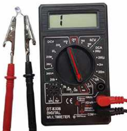
Fotografia 11. Sprawdzanie diody LED za pomocą multimetru ustawionego funkcję testowania diod. Po przyłożeniu sondy czerwonej do anody, a czarnej do katody, sprawna dioda LED powinna się zaświecić. Jeśli dioda ma odpowiednio długie (jeszcze nie przycięte) wyprowadzenia można się wspomóc krokodylkami
