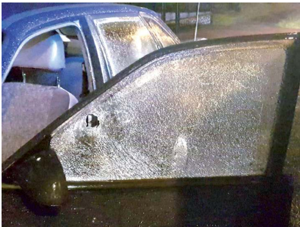
Uszkodzona szyba po domniemanym ostrzelaniu z wiatrówki
