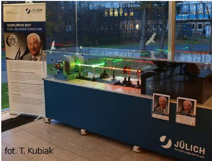
Fot. 4. Spektrometr rozpraszania światła Brillouina, który był wykorzystywany w pionierskich badaniach przez Petera Grünberga.
