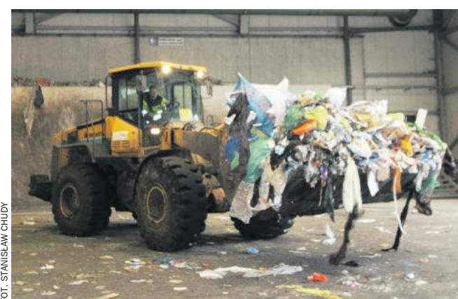
Odpady zmieszane trafiają zaraz do rozrywarki worków, skąd wyruszą na linię sortowniczą
