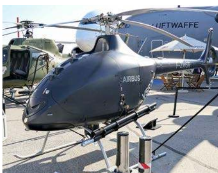
VSR700 z podwieszoną wyrzutnią dla dwóch lekkich kierowanych pocisków rakietowych Thales FZ275. Na ziemi widoczny pojemnik z wysuniętymi sonobojami do wykrywania okrętów podwodnych.
