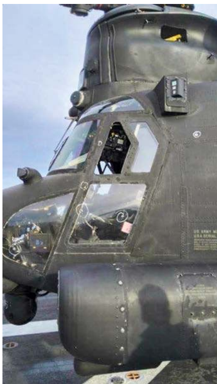
Pilotowany przez Slovera w pamiętnej akcji śmigłowiec MH-47G, który w widoczny sposób został wielokrotnie trafiony z broni małokalibrowej w okolicie kokpitu. Fot. US Army
