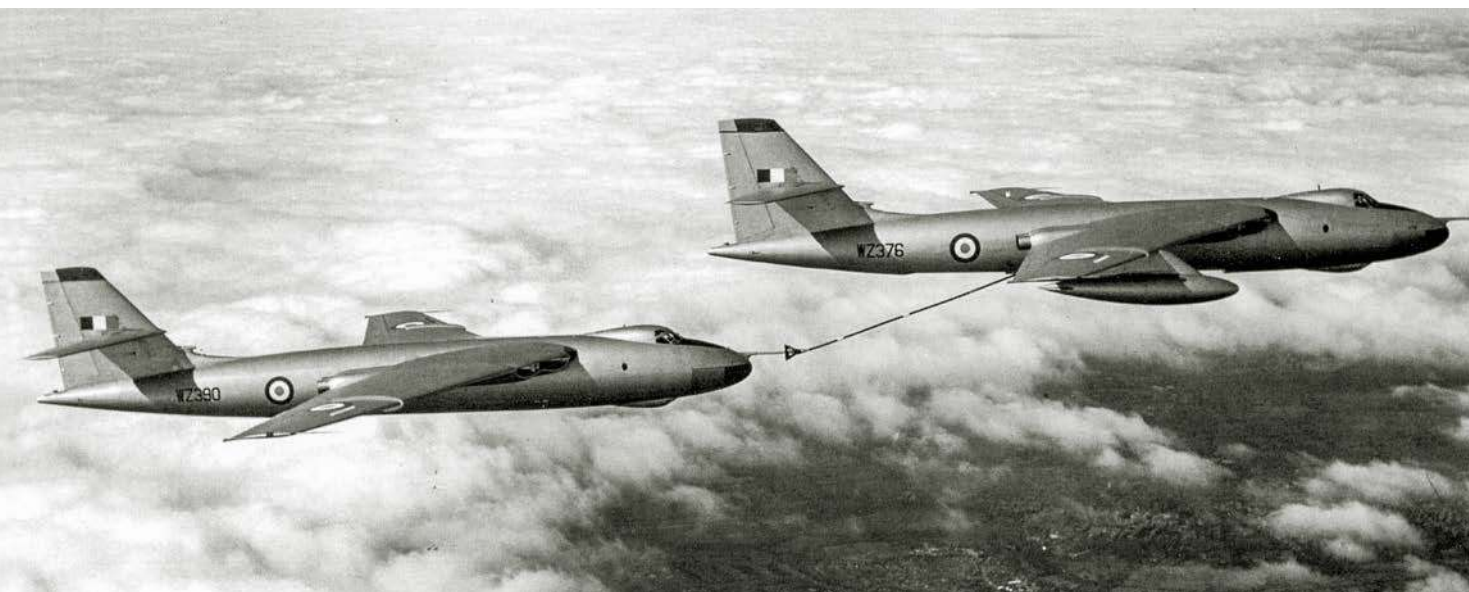
Prototypy wersji B(PR)K.1 (WZ376 i WZ390) podczas prób przekazywania paliwa w locie. Przystosowanie do funkcji latającego zbiornikowca polegało na zamontowaniu w komorze bombowej bębna z rozwijanym przewodem paliwowym zakończonym koszem. Ponadto w nosie kadłuba zamontowano stałą sondę do pobierania paliwa.
