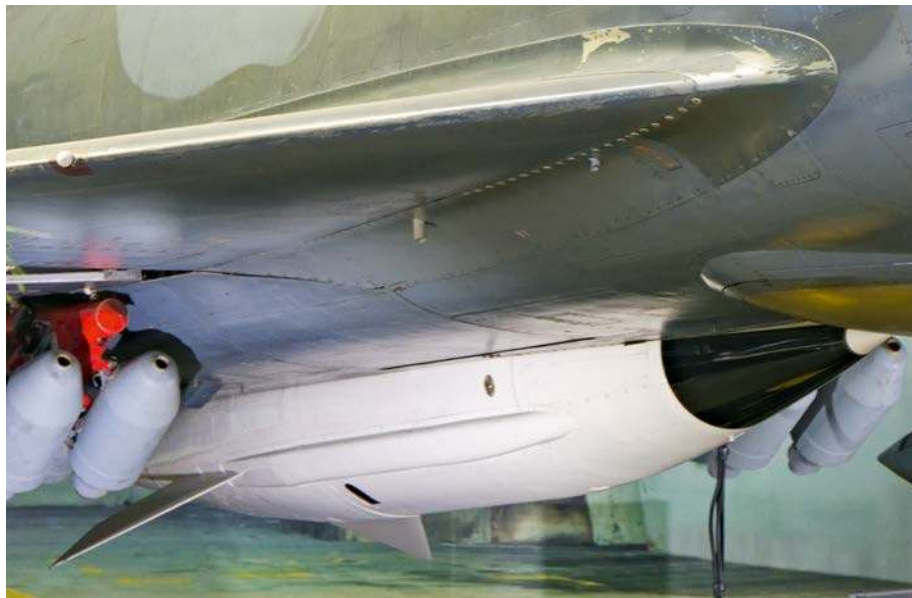
Podwieszona pod samolotem Mirage IV swobodnie spadająca bomba AN-11 o mocy 40 kt. Bomby tego typu były pierwszymi francuskimi bojowymi ładunkami jądrowymi. Weszły do użytku operacyjnego 1 października 1964 roku, wraz z pierwszą eskadrą naddźwiękowych bombowców strategicznych Mirage IV . Fot. Marcin Strembski
