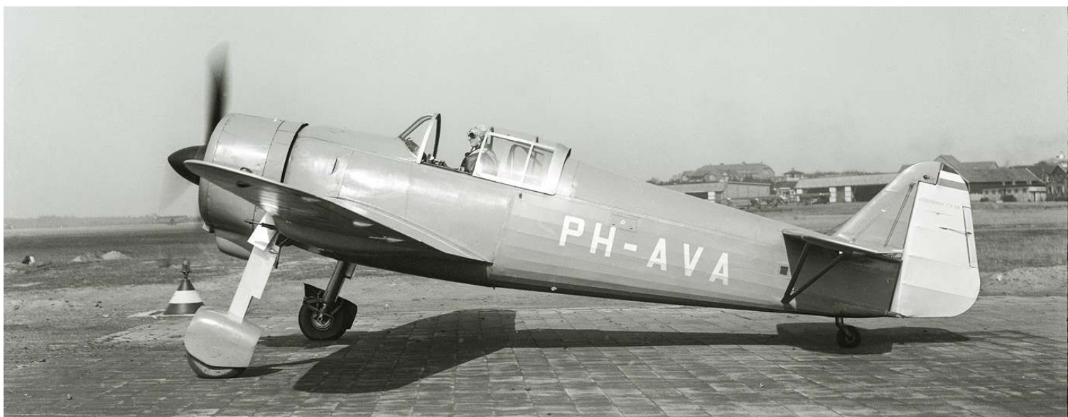
Drugi prototyp FK.58 demonstrowany w Soesterbergu 31 marca 1939 roku. Doskonale widać przednią część kadłuba pokrytą duraluminiowymi panelami i tylną pokrytą płótnem.
