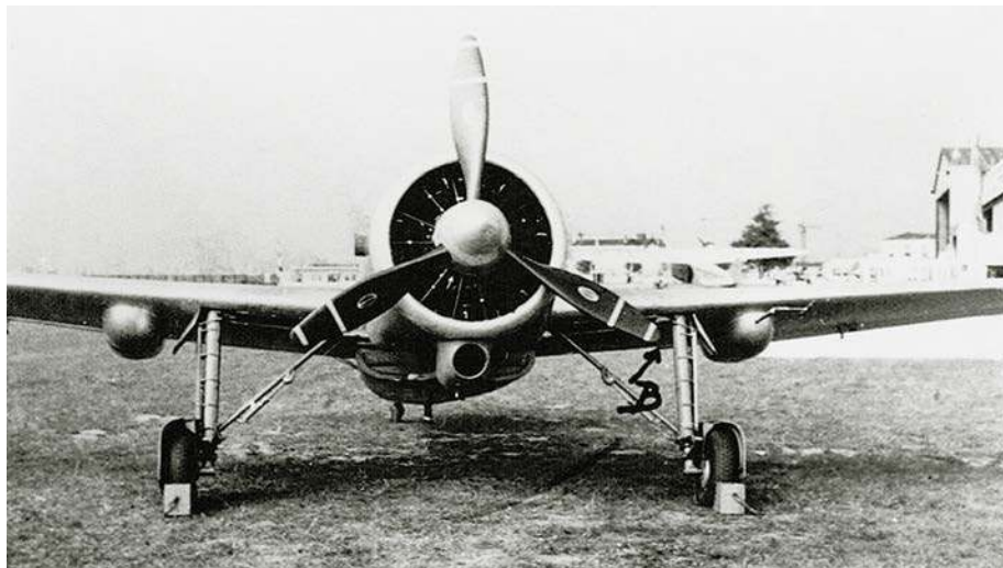
Pierwszy prototyp FK.58. Widoczne są różnice w budowie podwozia w porównaniu z drugim prototypem.
