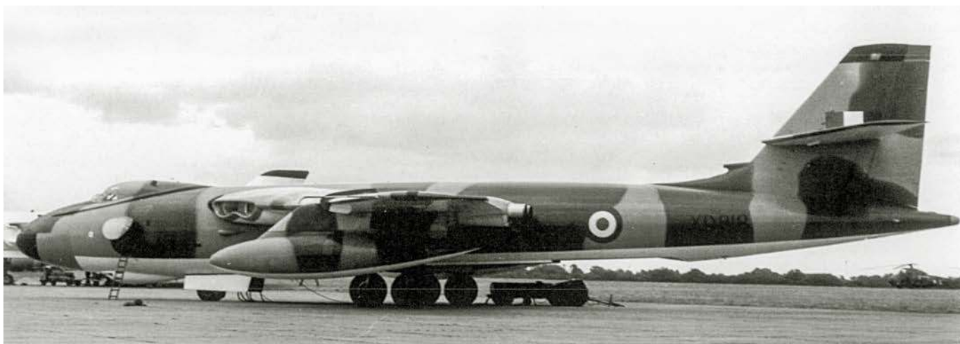
Valiant BK.1 (XD818) z No. 49 Squadron na początku lat 60., gdy eskadra była podporządkowana SACEUR. W tym czasie bombowce typu V wykonywały loty na małej wysokości, wobec czego przed końcem służby otrzymały szaro-zielony kamuflaż na górnych i bocznych powierzchniach.
