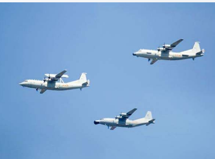
Transportowy Y-8 stał się w Chinach platformą dla licznych wariantów specjalistycznych. Na tym kadrze można zobaczyć samoloty w wersjach wczesnego ostrzegania i kontroli KJ-200 (po lewej), wczesnego ostrzegania Y-8J (w środku) i zwiadu elektronicznego Y-9JB (po prawej).
