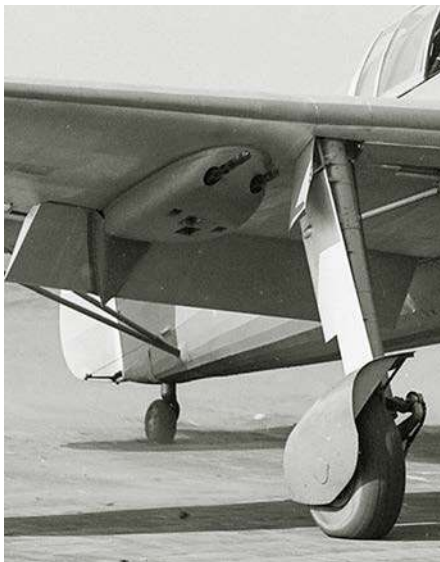
Zamontowana pod skrzydłem pierwszego prototypu FK.58 gondola z uzbrojeniem – dwoma karabinami maszynowymi FN-Browning Mle 38 kal. 7,5 mm.
