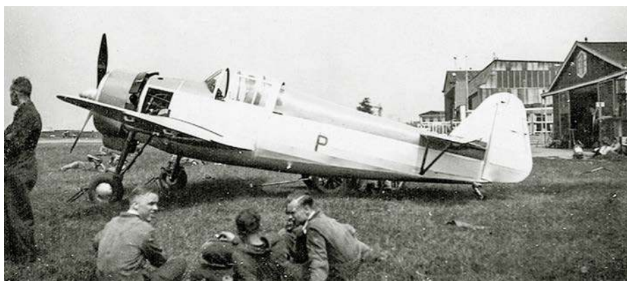
Widok na lewą stronę pierwszego prototypu. Widoczny zdjęty boczny panel odsłaniający instalację silnika Hispano-Suiza 14AA.
