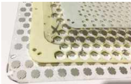
Rysunek 12. Część stosu układu fazowego po nieskomponowanej stronie płytki drukowanej anteny. Źródło: https://youtu.be/AlvIWF0AXIO
