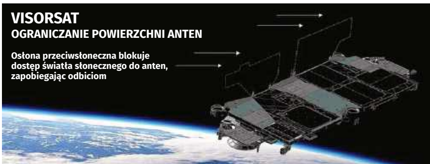
Rysunek 17. Ostona została dodana do późniejszych satelitów Starlink, aby zmniejszyć ilość światła odbijanego w kierunku Ziemi. Źródło: takie samo jak na rysunku 15
