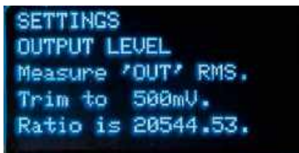
Ekran 3. Woltomierzem napięcia zmiennego lub innym przyrządem mierzymy wartość skuteczną sygnału na wyjściu i operujemy przyciskami UP i DOWN, aż miernik wskaże 500 mV. Następnie naciskamy OK
