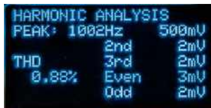
Ekran 10. ANALIZA HARMONICZNA dostarcza informacji o zawartości harmonicznych w badanym przebiegu. Dobrym sposobem sprawdzenia tej funkcji jest dołączenie wejścia analizatora do wyjścia
