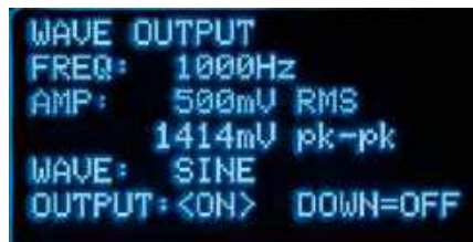
Ekran 7. Na stronie WAVE OUTPUT naciśnięcie OK powoduje przechodzenie między parametrami, a przyciski UP i DOWN modyfikują je. Kształt przebiegu wyjściowego można ustawiać również poprzez port szeregowy USB
