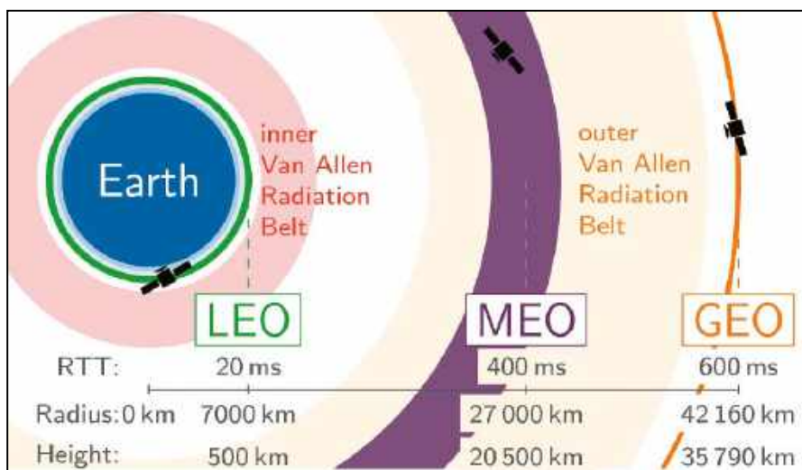
Rysunek 2. Porównanie cech kilku wysokości orbitalnych. RTT to czas podróży sygnału radiowego w obie strony. Najlepiej unikać pasów radiacyjnych Van Allena. Promień jest liczony od środka Ziemi, natomiast wysokość jest liczona od powierzchni Ziemi. Źródło: https://www.wiki/6H8X
