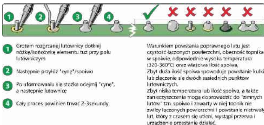
Rysunek 17. Wskazówki dotyczące sposobu lutowania
