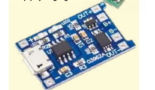
Zdjęcie 3. Moduł TP4056, przeznaczony do ładowania ogniw akumulatorów Li-ion lub LiPo. Automatycznie odłącza obciążenie, jeśli napięcie na jego zaciskach spadnie do zbyt niskiej wartości
