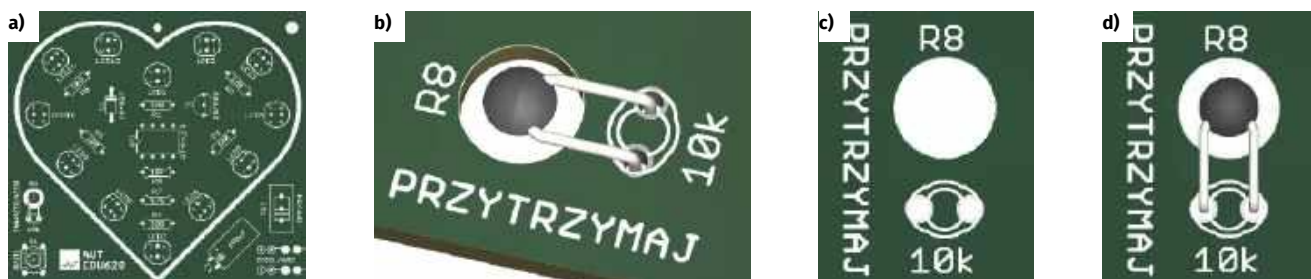
Rysunek 12. a) lokalizacja termistora NTC na płytce; b), c), d) poprawny montaż tego elementu
