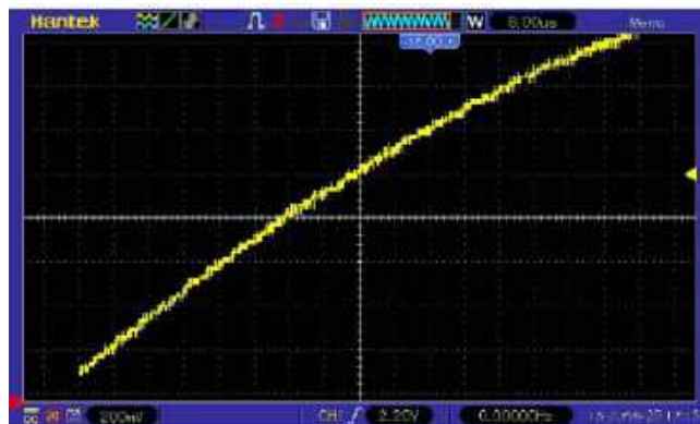
Rysunek 4. Szum kwantyzacji widoczny na ekranie oscyloskopu cyfrowego © 2020 Jos Verstraten
