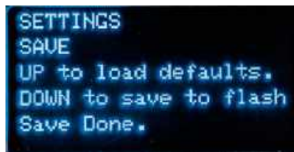
Ekran 6. Ekran ten pojawi się, gdy naciśniemy OK ponownie. Wciskamy DOWN, aby zapisać wartości parametrów kalibracji w pamięci FLASH. Pojawi się komunikat potwierdzający wykonanie tej czynności
