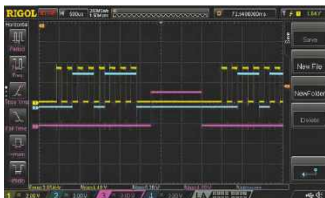
Rysunek 7f. Komunikacja szeregową po SPI: kanał żółty – SCLK, kanał niebieski – SDATA, kanał fioletowy – strobe/latch
