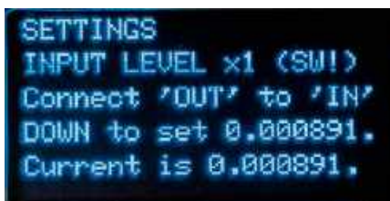
Ekran 4. Aby wykonać kolejne kroki kalibracji, łączymy kablem z wtykami RCA wyjście z wejściem. Upewniamy się, że przełącznik zakresu S6 jest ustawiony na 1x. Po wyświetleniu wiersza za-chęty naciskamy DOWN, a następnie OK
