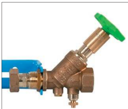
Fot. 1. Zabezpieczenie antyskażeniowe – zawór skośny zaporowo-zwrotny Źródło: EWE
