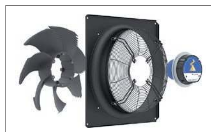
Rys. 1. Elementy składające się na kompletny wentylator: wirnik, stojan umożliwiający stabilne mocowanie wirnika i silnika oraz elementy istotne (np. osłona aerodynamiczna), silnik Źródło: Ziehl-Abegg
